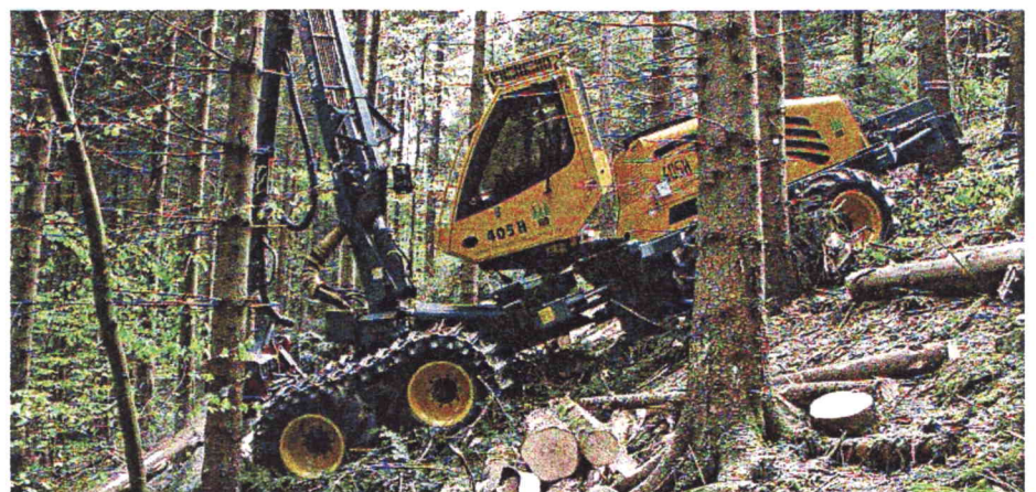
Der Vollernter HSM 405H2L 8WD ist am Heck mit einer tiltbaren und synchron zum Antrieb laufenden Traktionshilfswinde ausgestattet.
