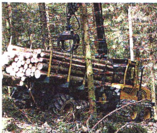
Der Tragschlepper HSM 208F fährt durch die Traktionshilfswinde ohne Schlupf.
